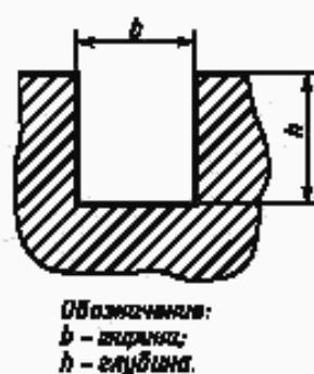
Рисунок 1 — Сечение выемки
